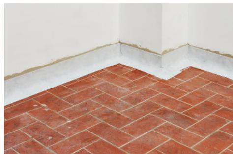
Si può coprire con cemento o pittura **senza tempo d'attesa**. Il ricoprimento di pittura, mortero, etc, deve essere flessibile - elastico e compatibile con la natura della benda (la resina di butilo è sensibile a li solventi). Raccomandiamo il uso della malta flessibile AGUAPLAST IMPERELASTICO e della pittura impermeabile LISOMAT STOP WATER LEAKS.
